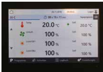
Steuerungseinheit einer Klimakammer
