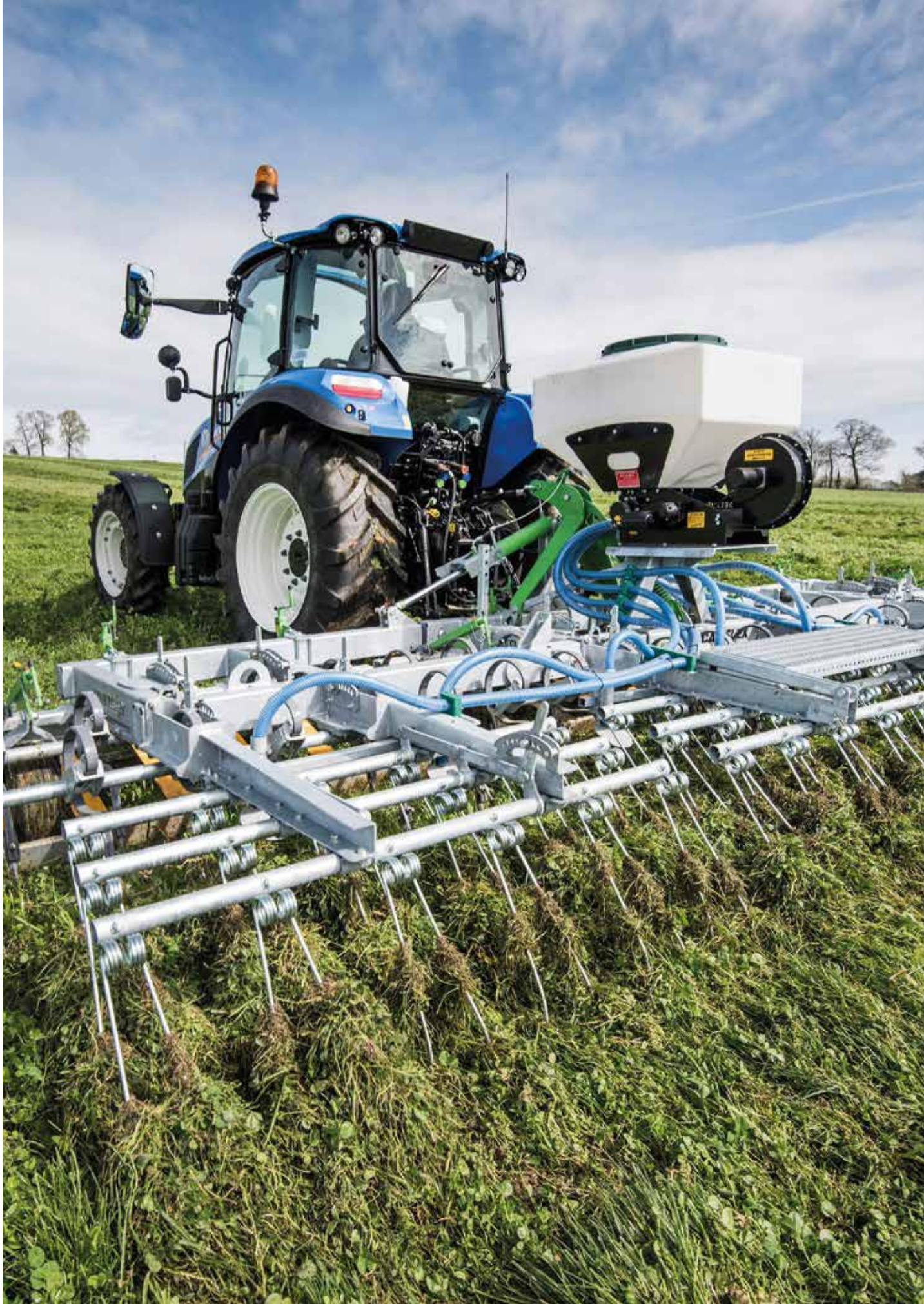
Mit modernen Kombinationsgeräten können die Vorteile von Striegeln und Schleppen vereint und gleichzeitig die Grünlandnachsaten durchgeführt werden.
